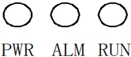
PWR：24V 供电状态，绿灯常亮则供电正常，不亮请检查 24V 电源信号
