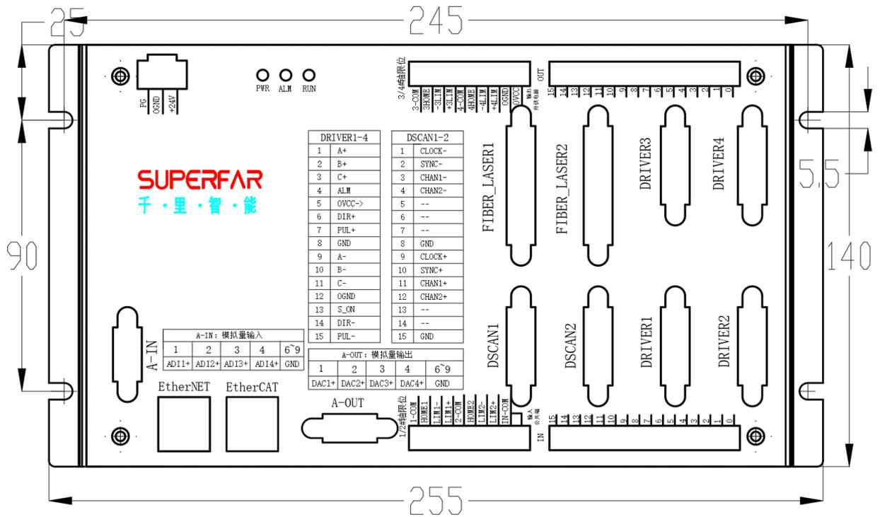
QLS-422 控制卡是千里智能自主研发的高端平台振镜联动卡,采用强大的 CPU 计算,主要用于有多轴运动的平台、振镜、激光的加工应用中,实现平台振镜联动,大大提高加工效率,如 3D 打印, PCB/FPC,指纹识别芯片,摄像头模组等激光精密切割,大幅 PCB 打标,晶圆打标等。
